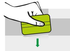
**6.** Skrab ett kors; skrab fra midten mot venstre, skrab fra midten mot høyre, skrab fra midten opp, skrab fra midten mot bund. **TAG EN FIRKANT AD GANGEN, HUSK AT STARTE FRA CENTRUM AF KORS OG PRES ALT VANDET UD MOT KANTEN AV FOLIEN. SKRAB GODT, SÅ DU ER SIKKER PÅ Å VANDER ER HELT UDE.**
