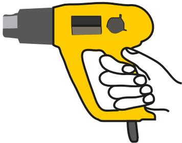
**3.** På steder hvor folien skal trekkes ut over emnet, varm da folien med en varmepistol, for å lage folien fleksibel. Når folien varmes opp formes/trekkes den forsiktig ut over montagestykket. **HVIS FOLIEN BLIVER STRUKKET FOR MYE, KAN DU GJENOPRETTE DEN OPPRINDELIGE FORM VED AT OPVARME DEN IGJEN.**
