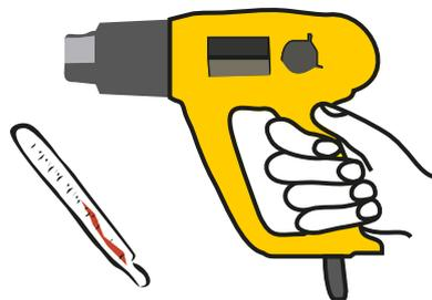
**5.** Når installasjonen er fullført må folien varmes opp til ca. 95 grader °C, for at folien skal "glemme" sin opprinnelige form. Hvis ikke folien mottar denne varme, vil folien langsomt trekke seg tilbake til opprinnelig form.
