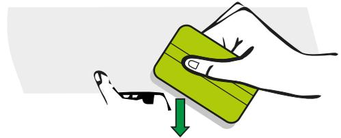
**2.** Monter folien fra den ene ende og arbeid deg langsomt fremover, folien skrapes på alle flater først og indvarmes deretter oppvarmet i alle bretter.
